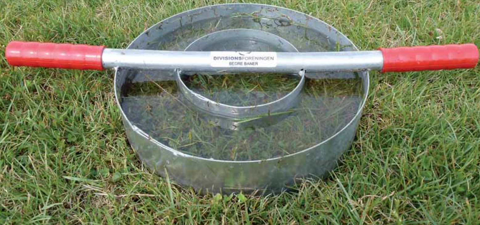
Måling af vandinfiltration. Dobbelttringene bankes ned i græsoverfladen og fyldes med vand. Efter vækstlaget har været vandmættet i 20 minutter, fylder man ringene helt op med vand igen. Efter 20 minutters henstand måler man hvor mange mm vand der er sunket i den inderste ring - ganger med tre og så har man vandinfiltration i mm/time. Foto: Asbjørn Nyholt.
